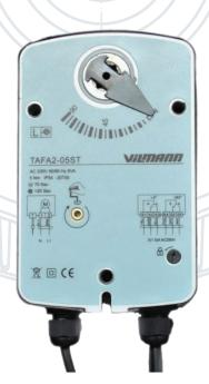
Встроенные микропереключатели обеспечивают сигнализацию положения заслонки. Перевод в защитное положение снятием питания с привода или разрывом цепи питания термодатчиком NTS72.
